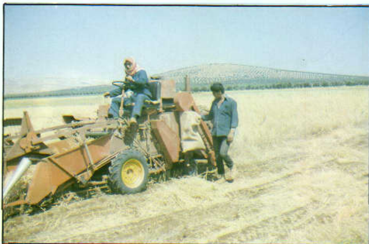
صورة رقم / ١٦ / : توضح كيفية الحصاد ومدى فعاليته والتعبئة بالاكياس مباشرة .
