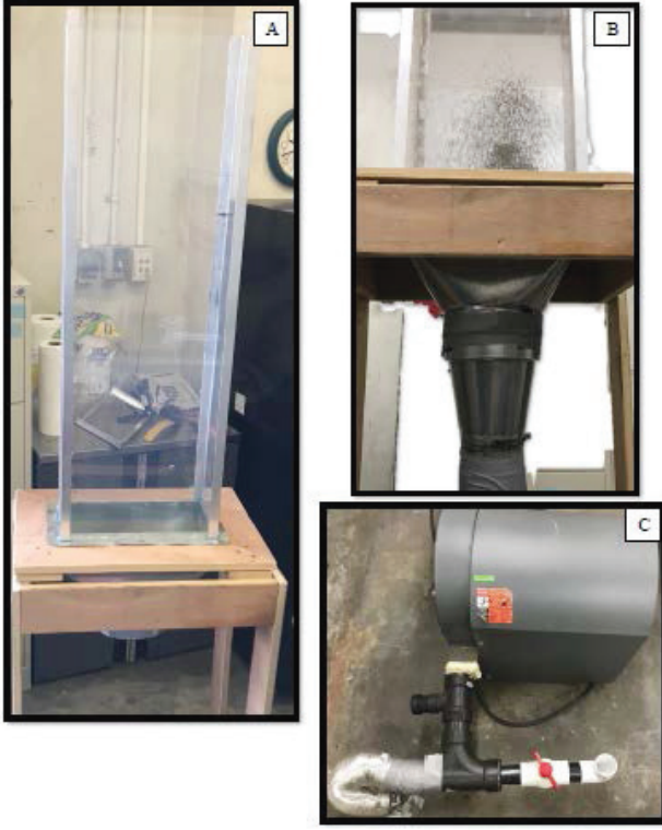
الشكل (6): نظام سرير مميغ لإزالة مادة الصابونين. A: منظر جانبي للنظام غير متصل بالمنفاخ B: توصيل الهواء بالنظام / C: إعداد المنفاخ
