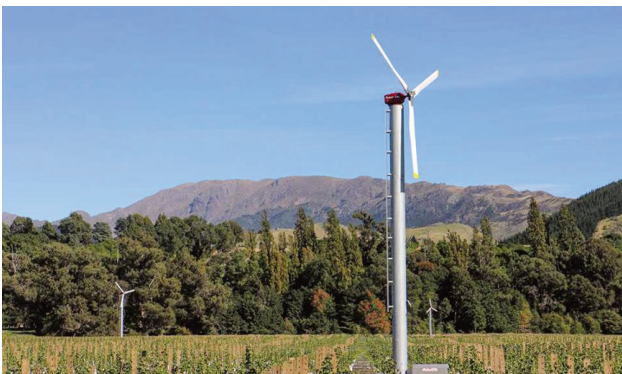
الشكل (4): المراوح الهوائية للوقاية من الصقيع
